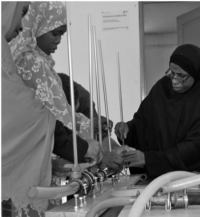
Bild 2: Veranschaulichung der Bernoulli-Gleichung in einer Rohrströmung, Karume Institute of Science and Technology, Sansibar
