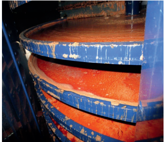
Trocknen von Fettschlamm aus einer Flotation
