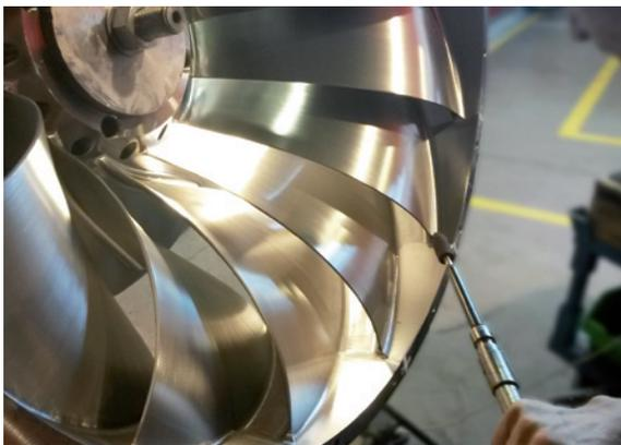
*Alle Laufräder werden per Hand vollflächig geschliffen*
