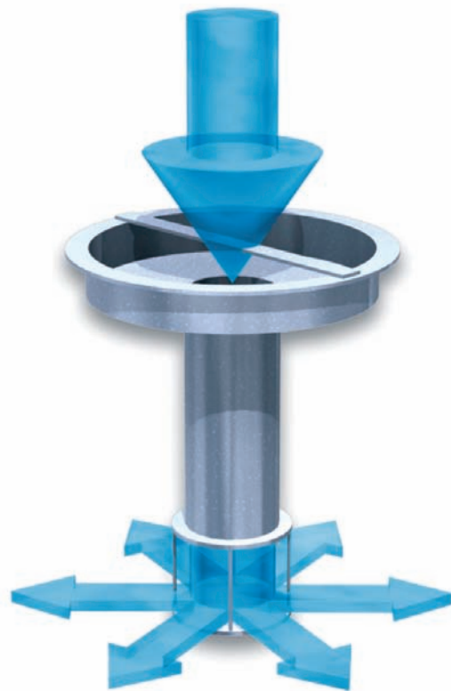
Wirkprinzip der Einsatzkonstruktion, der sogenannten „Prallplatte“
