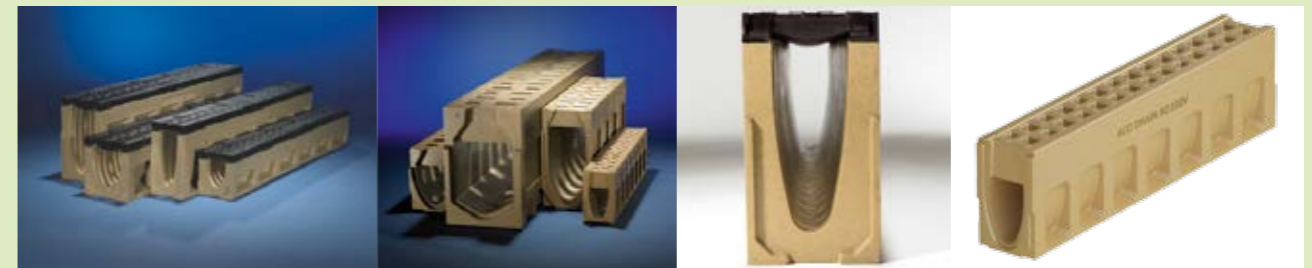
Bild 1: ACO DRAIN® Powerdrain Schwerlastrippen aus Polymerbeton sind in vier Nenngrößen und bis zur höchsten Belastungsklasse (F 900) gem. DIN 1433 lieferbar.
