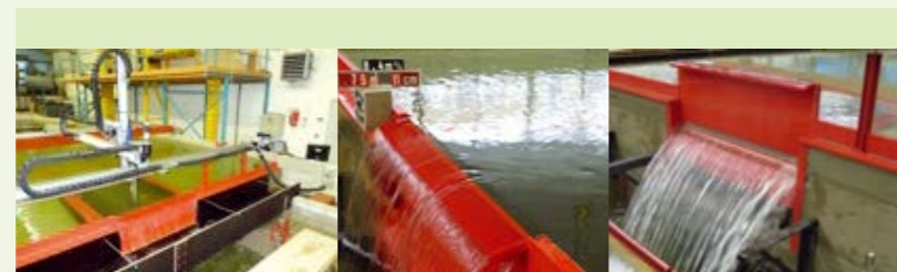
Versuchsstand „Schachtkraftwerk“ in verschiedenen Betriebszuständen
