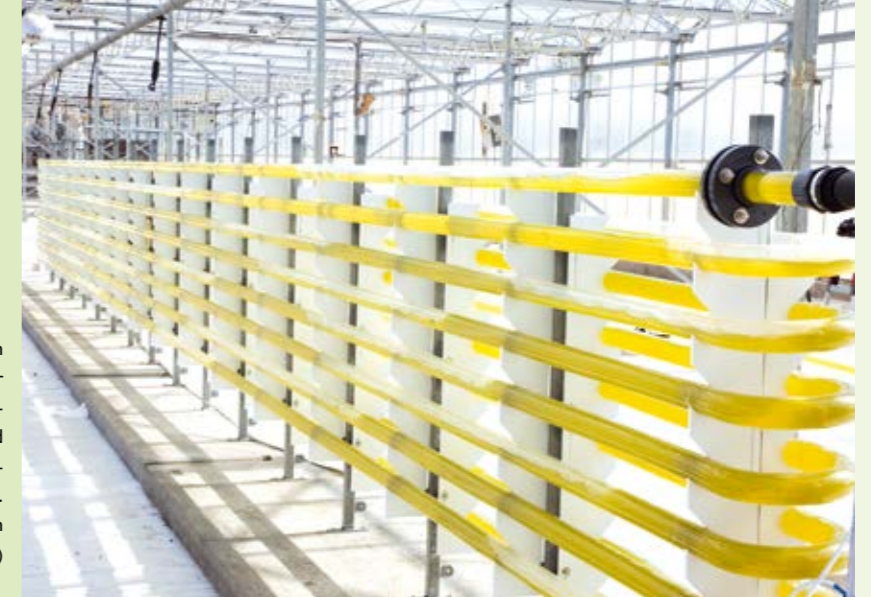
Abbildung 6: Röhren-Photobioreaktoren auf Basis von 63x0,5mm Rohren aus einer speziell hierfür entwickelten transparenten PVC-Rezeptur. Der Reaktor wird mit der Marken-geschützten „Bubble-Brush“™-Technologie betrieben. (Foto: Mit freundlicher Genehmigung von LGEM B.V.)
