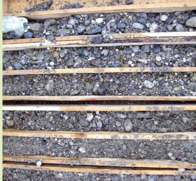
Abbildung 5: Lagerung Aushub in Kernkisten
