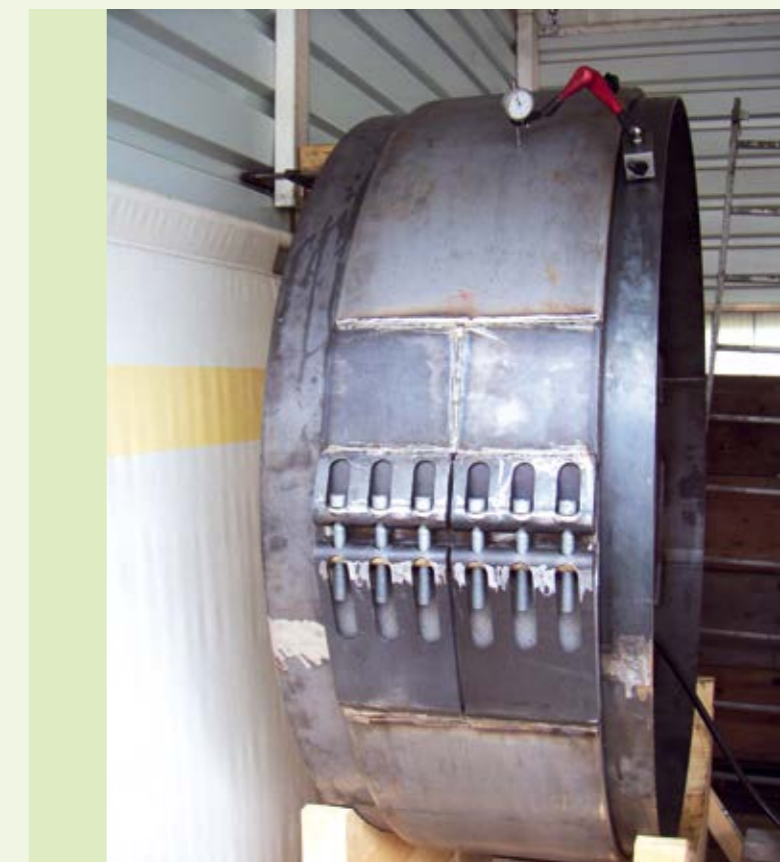
Die STRAUB-OPEN-FLEX 4H 1670 mm auf dem Prüfstand.
