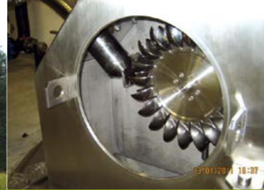
Abbildung 1: Das neue Wasserwerksgebäude Abbildung 2: Die Peltonturbine geöffnet Abbildung 3: Die Peltonturbine mit Düsenanstellantrieb und Asynchrongenerator Abbildung 4: Die vierstraßige Ultrafiltrationsanlage
