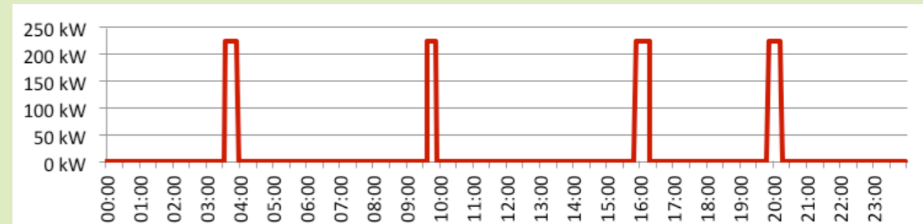
Abbildung 5: Ausgleichsenergiebedarf mit KraftWare® (24h)
